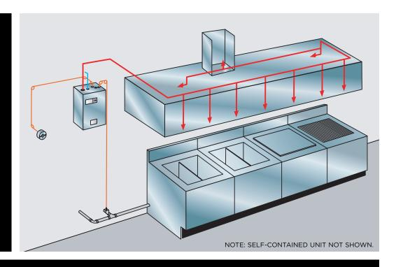
PRX™ LIQUID FIRE SUPPRESSANT ■ OVERLAPPING PROTECTION
